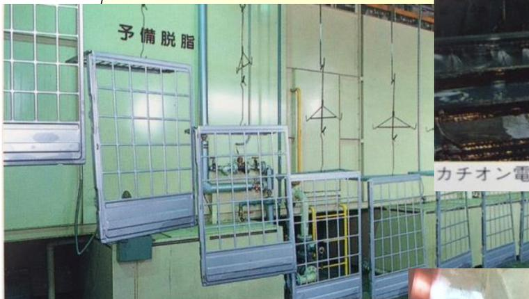
リン酸亜鉛被膜処理工程
